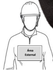
La argolla esternal está especialmente diseñada para conectar un dispositivo anticaídas automático de progresión vertical, utilizado para progresión en torres de telecomunicaciones, de alta tensión y en todo trayecto ascendente o lateral que requiera protección permanente ante los riesgos de trabajos en altura.
